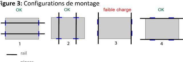
Les configurations 1 et 2 montrent un montage avec un rail support, 3 et 4 montrent un montage sans rail support. Dans les configurations avec un rail support, les rails deviennent standard ou les rails transversaux tandis que « Sans rail support » devient fin montage d'extrême sur le côté long ou court.
