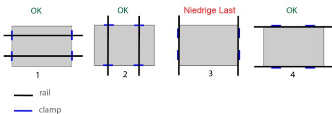
Die Konfigurationen 1 und 2 zeigen die Montage mit Schienenstütze, 3 und 4 zeigen die Montage ohne Schienenstütze. In "mit Schienenstütze" werden die Schienen konventionell oder quer installiert, während "Ohne Schienenstütze" bedeutet Endmontage (langer oder kurzer Seite).
