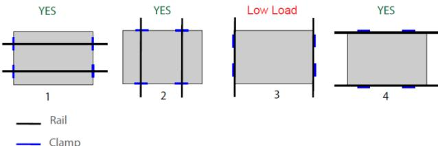
1及び2の構成は、クランプを支えるレールがパネルの下部分を通過しているもので、3及び4はクランプを支えるレールがフレーム部分に沿って敷かれているものです。3の構成では、大きな荷重に耐えることはできません。
