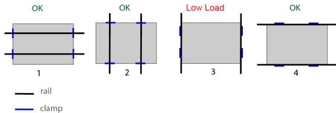
Las configuraciones 1 y 2 muestran el montaje con soporte de riel, 3 y 4 muestran el montaje sin soporte de riel. En "Con soporte de riel" los rieles se vuelven convencionales o los rieles transversales, mientras que "Sin soporte de riel" se monta en el extremo en el lado largo o corto.
