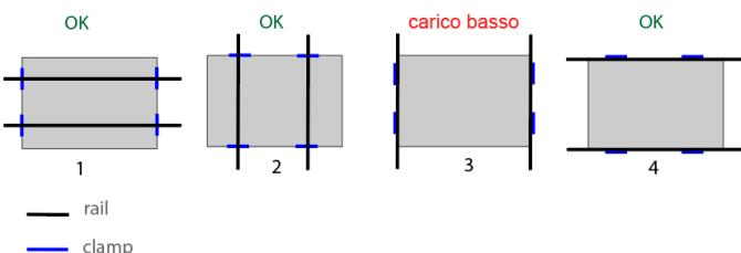
Le configurazioni 1 e 2 mostrano il montaggio con supporto ferroviario, 3 e 4 mostrano il montaggio senza supporto ferroviario. In "Con supporto ferroviario" le rotaie diventano convenzionali o le rotaie trasversali mentre "Senza supporto ferroviario" diventa end montato su un lato lungo o corto.
